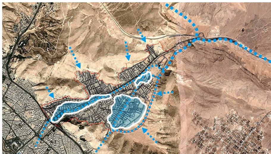
شکل ۱۷: پهنه متأثر از سیل فروردین ۱۳۹۸ در محدوده شهرک سعدی شیراز (برگرفته از هیئت ویژه گزارش ملی سیلاب‌ها، ۱۳۹۸).
